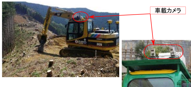
モニター4台の映像を見て1台の建設機械をコントロール
