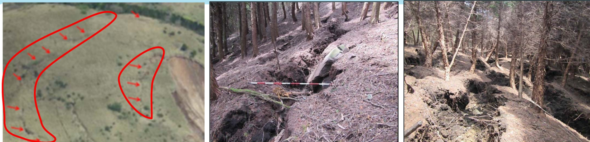
阿蘇大橋地区西側斜面の崩壊箇所 上部亀裂状況
