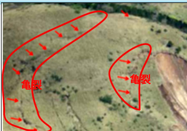
①阿蘇大橋崩壊斜面 上部亀裂状況
